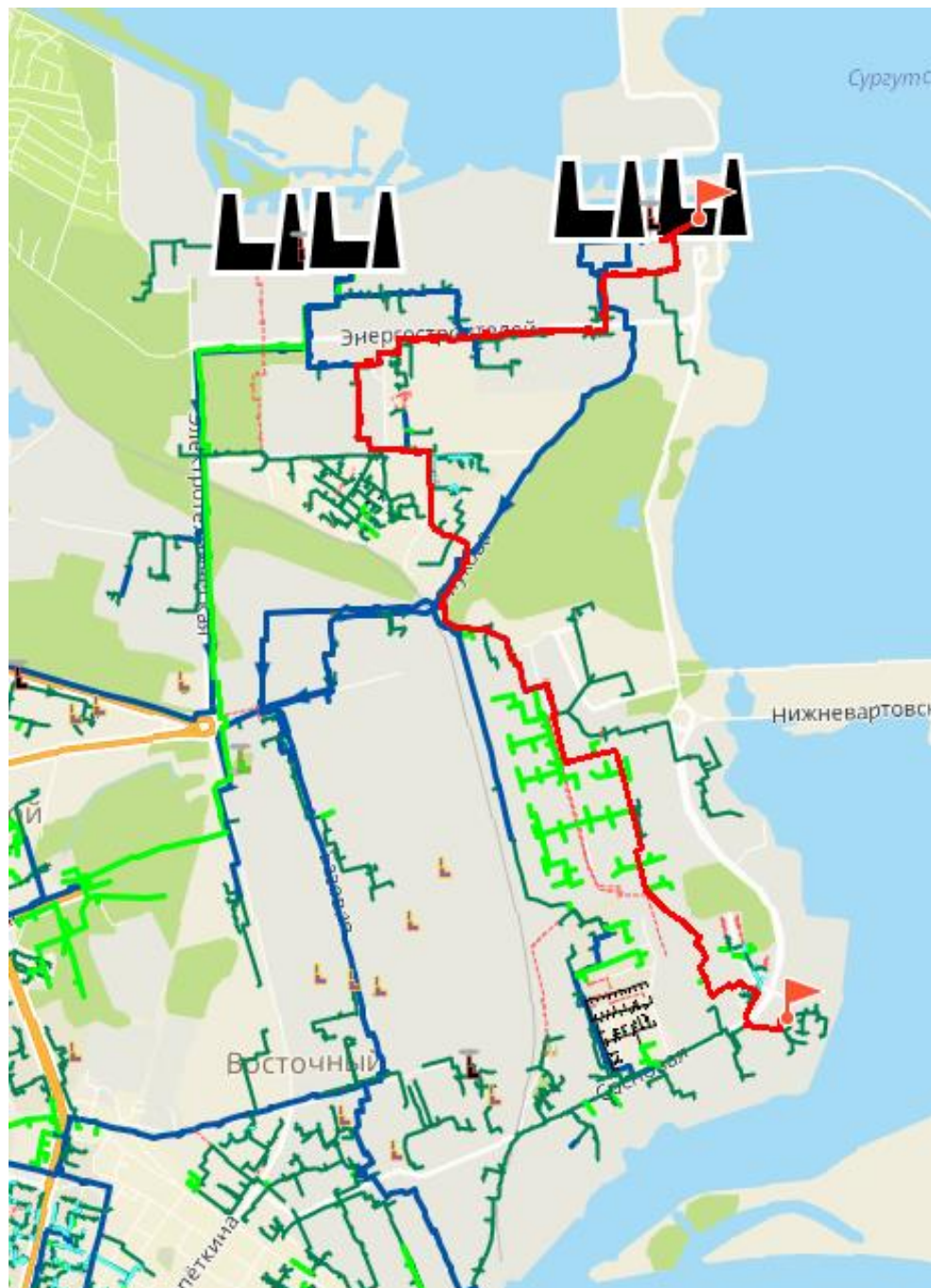
Рисунок 3.7 – Путь движения теплоносителя от источника тепловой энергии до конечного потребителя, в зоне действия СГРЭС-2 (Промзона) (рисунок П46.1 МУ)
