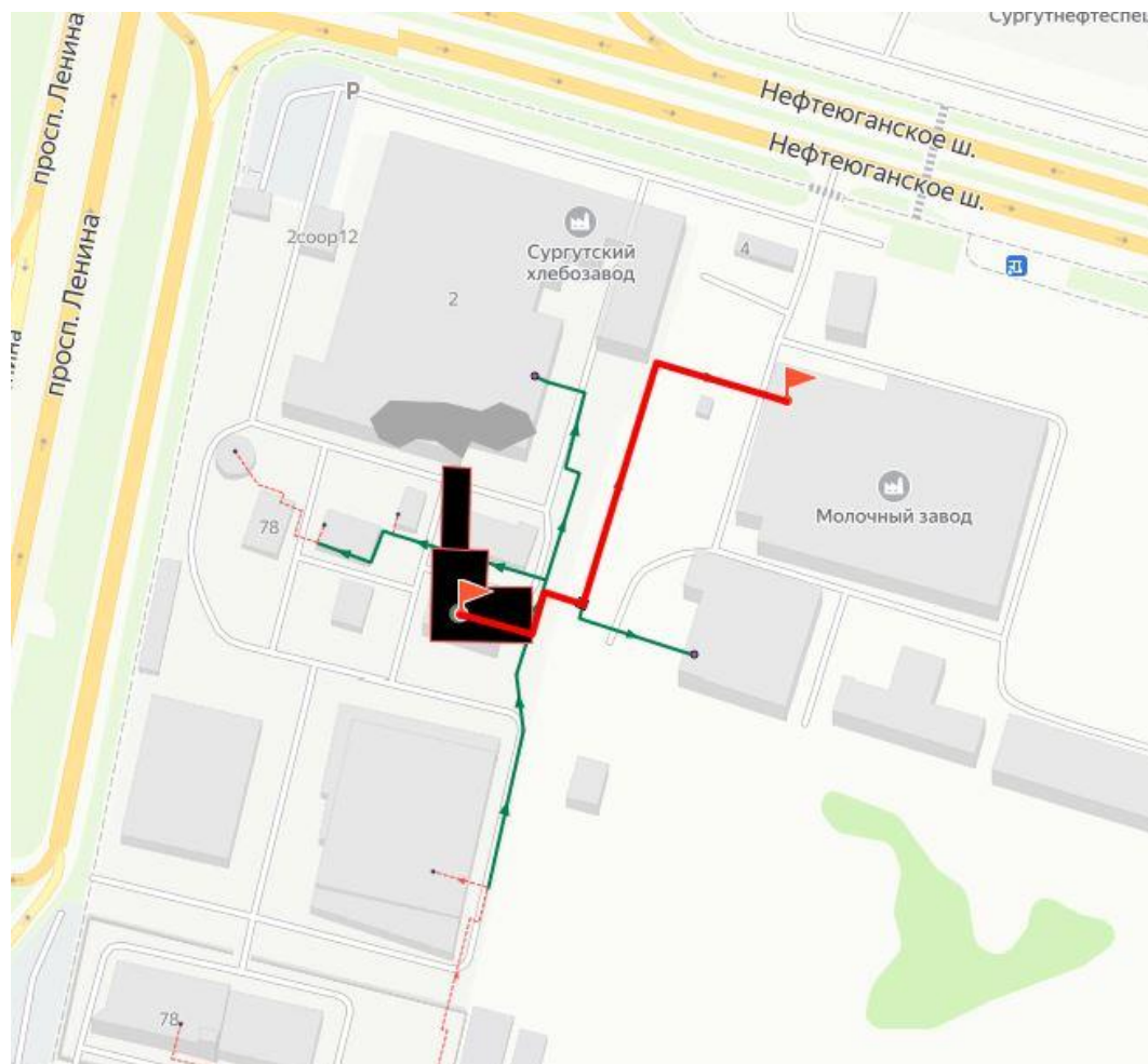
Рисунок 3.93 – Путь движения теплоносителя от источника тепловой энергии до конечного потребителя, в зоне действия котельной АО «Сургутский Хлебозавод» (рисунок П46.1 МУ)
